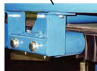
**LOS MONTAJES DE RODILLOS HUMECTADORES** reducen las pulsaciones en el ajuste de la banda cerca de los martillos.
