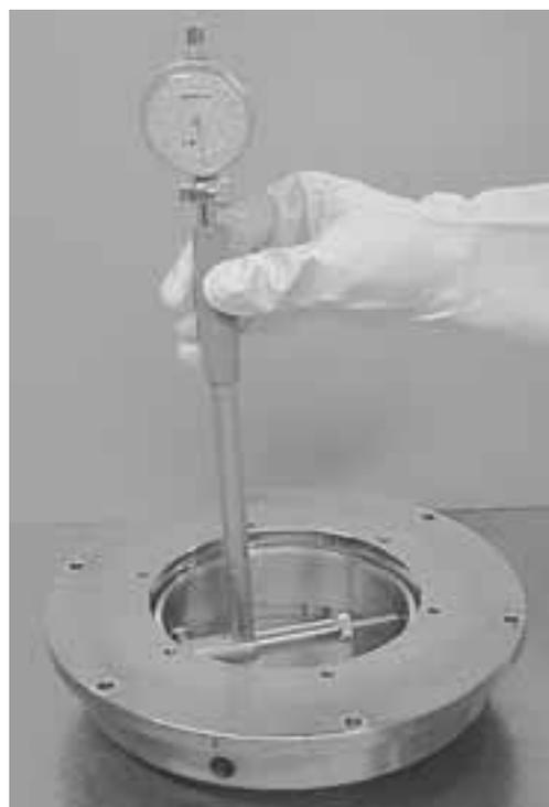
Fig.1.11 Ajuste el Diámetro Inscrito del Calibrador GN
