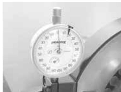
Fig. 1.15 Medición de la Anchura del Separador
