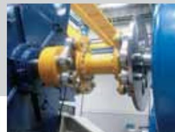
■ Acoplamiento elástico de bielas IXILFLEX®
