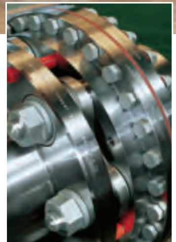
Detalle de Lamidisc DO-675-8 SP con aislamiento eléctrico.
