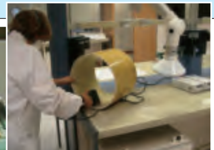
Preparación superficial del Eje de Composite.
