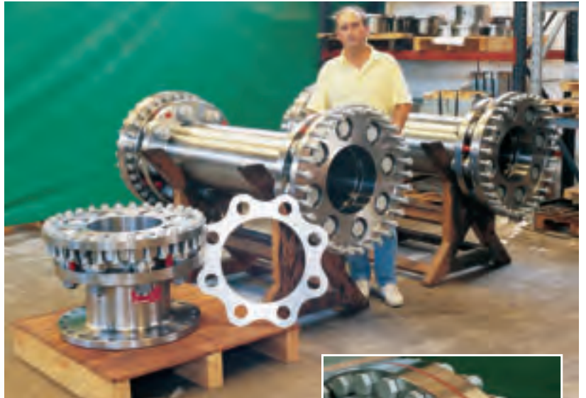
Lamidisc DO-675-8 SP para propulsión marina (waterjet). (11.640 kW a 558 rpm)
