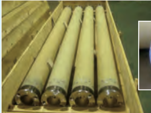
Ejes de fibra de vidrio de Lamidisc SXGF-228-6/3296 MM para Torres de Refrigeración con unión atornillada y adhesiva.
