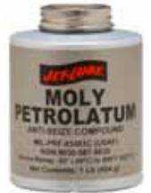
El propósito del uso del compuesto Moly Petrolatum es prevenir la adhesión mecánica durante el ensamble y desensamble de las conexiones roscadas y accesorios a temperaturas debajo de los 800°F y cumplir y exceder los requerimientos de la especificación militar MIL-T- 83483B para instalaciones y ensambles de partes de aviones. Es también usado para proveer protección contra la corrosión en superficies metálicas.
